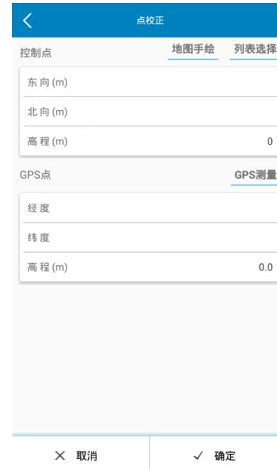
当任务数据使用当地网格平面坐标，或者任务中的地图数据与实际定位坐标存在偏差时，可通过使用辅助工具箱中的【点校正】功能，进行点位坐标的偏移校正操作：
